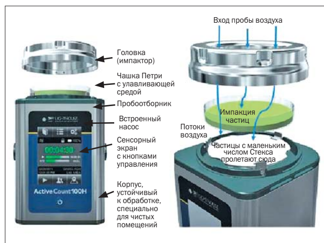
Рис. 3. Портативный микробиологический пробоотборник и распределение воздушных потоков между головкой и улавливающей пластиной
